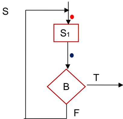
Dopo l’esecuzione di  $S_1$  si deve valutare B per cui al codice per B viene premessa un’etichetta che è il valore di  $S_1.next$  (pallino blu).
