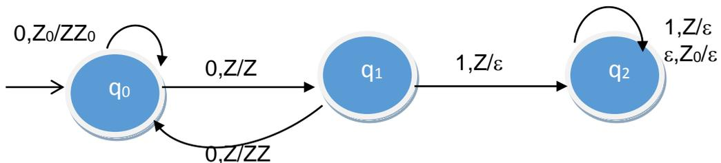
6. L'automa P ha la seguente funzione di transizione (le parentesi graffe sono state omesse in quanto la funzione di transizione ha un solo valore per ogni elemento del dominio,  $\delta: Q \times (\Sigma \cup \{\epsilon\}) \times \Gamma \rightarrow Q \times \Gamma^*$ )
