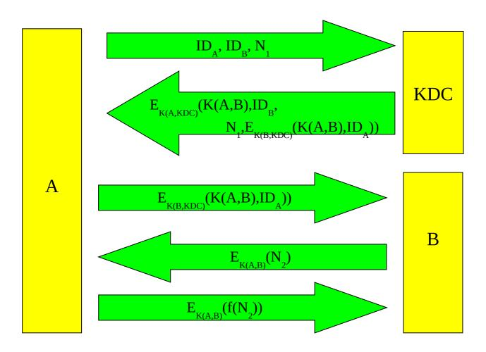
I valori N1 ed N2, detti "nonce" servono per evitare attacchi di tipo "replay" – in particolare i messaggi 4 e 5 servono a B per verificare che A possieda effettivamente la chiave K(A,B).
