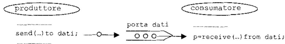
Figura 8.6 Singolo produttore/singolo consumatore.
